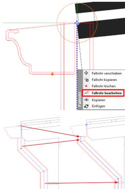
Klicken Sie wieder 2x auf das Fallrohr und wählen Sie anschließend **Fallrohr bearbeiten**.
