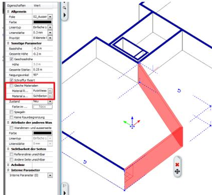
Sie können im 3D Modus die Materialien einer Wand tauschen. Markieren Sie die Wände mit gedrückter **SHIFT Taste**.
