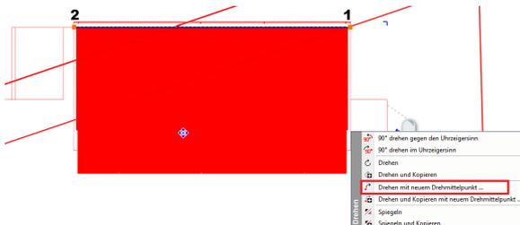
Wählen Sie dazu den **Drehen mit neuem Drehmittelpunkt** Befehl aus dem Marker Menü.
