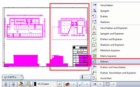
Verlängern wir den Plankopf nun mit dem **Dehnen** Befehl aus dem **Verschieben** Drop Down der Status Leiste.
