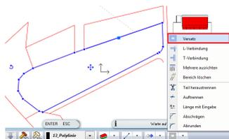
Verwenden Sie das Versatz Werkzeug aus dem 2D Bearbeiten Drop Down Menü der Status Leiste.
