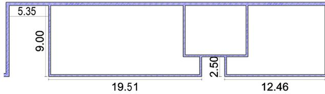
Für die Fertigstellung der restlichen Innenwände verwenden Sie die Längen laut Abbildung.
