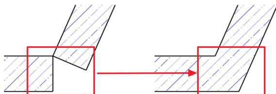
Verbinden Sie abschließend die Ecke so, das die Wand in einem durchgeht.
