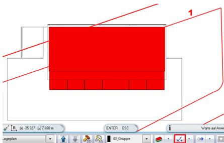
Wählen Sie unmittelbar danach den Befehl **Distanz von Schnittpunkt** aus dem Drop-Down der Statusleiste.
