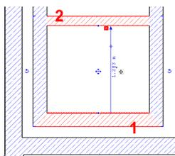
Aktivieren Sie mit der linken Maustaste die erste horizontale Außenwand (1), halten Sie nun die **SHIFT Taste** gedrückt und klicken Sie mit der linken Maustaste auf die Trennwand (2).
