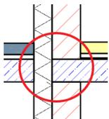
Ändern Sie das **Basis Niveau** der Dämmschicht auf -0,35 m. (in den Attributen)
