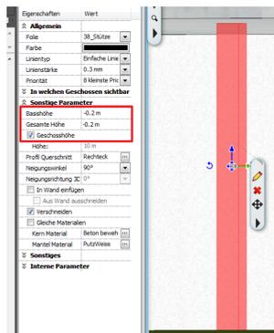
Die Säule am Balkon der Wohnung über dem Lift-Treppenhaus wird nun in das Erdgeschoss kopiert. Passen Sie diese an.
