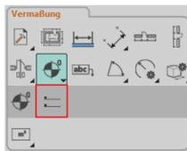
Wechseln Sie in Ihren Schnitt und aktivieren Sie den Befehl **Schnittvermaßung** aus dem Bereich Vermaßung.
