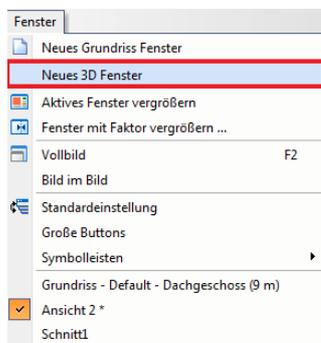
Wählen Sie den **Neues 3D Fenster** Befehl im **Fenster** Menü aus. Es öffnet sich ein neues 3D Fenster mit der Standard Darstellung **Axonometrie**.
