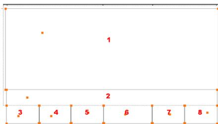
Dieser Befehl erkennt die Kontur der Schraffur automatisch, vorausgesetzt Sie klicken in geschlossene Konturen.
