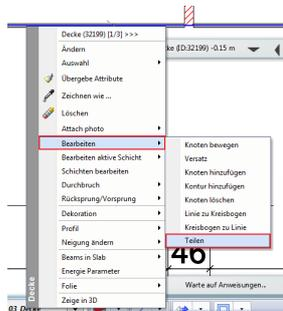
Klicken Sie mit der rechten Maustaste auf die Decken Kontur. Wählen Sie unter dem Punkt **Bearbeiten** den Befehl **Teilen**.
