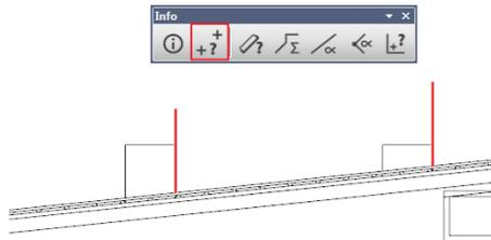
Wechseln Sie in den Schnitt und messen Sie sich den Höhenunterschied zur bestehenden Höhe aus.
