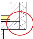
Die thermische Trennung wird korrekt dargestellt und schließt mit der Decken Unterkante.
