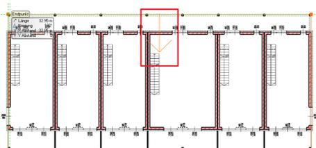
Danach muss jene Seite der Dachfläche angegeben werden, von der aus die Dachneigung aufgetragen wird.
