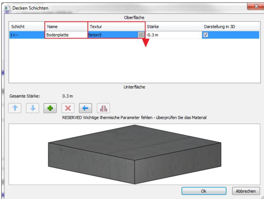
Schließlich muss noch die Darstellung im Schnitt angepasst werden, die bei ARCHline mit dem Material (Textur) verknüpft ist:
