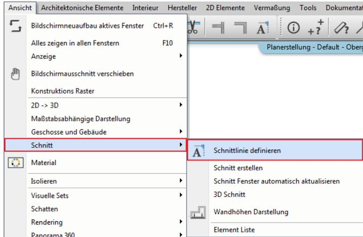
Führen Sie den Befehl **Schnitt platzieren** aus dem Ansicht Menü aus.
