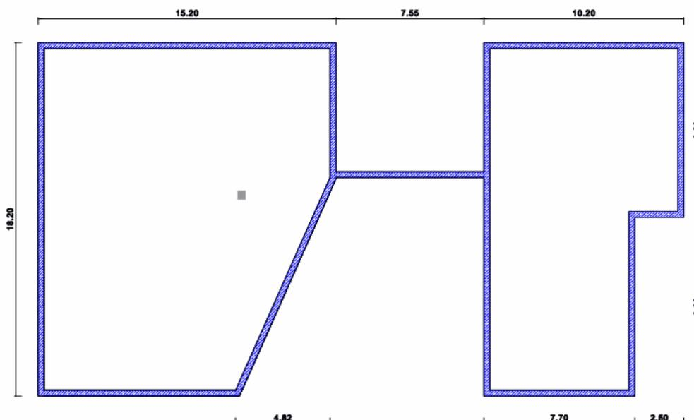
Verwenden Sie anschließend den **L-Verbindung** Befehl
