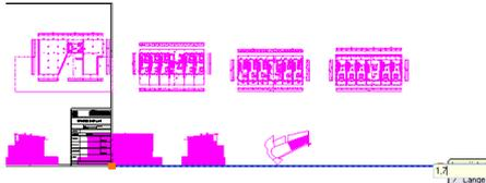
Geben Sie danach den Startpunkt der Dehnung an und bewegen Sie die Maus nach rechts. Tippen Sie anschließend 1,7 ein.
