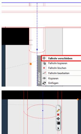
Markieren Sie das Fallrohr und klicken Sie nochmals. Wählen Sie anschließend **Fallrohr verschieben**.
