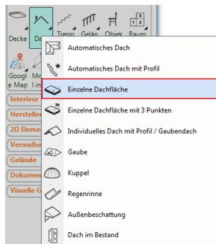
Verwenden Sie dazu den Befehl **Einzelne Dachfläche**.
