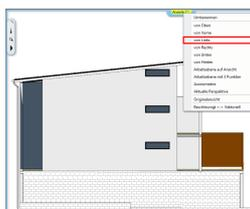
Wechseln Sie in die Ansicht "**von Links**" um auch hier das Fallrohr korrekt zu positionieren.
