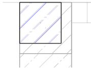
Platzieren Sie die erste Säule über der Erdgeschosssäule des linken oberen Gebäude Ecks.
