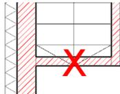
Zuerst muss die mit dem roten X versehene Wand entfernt werden.
