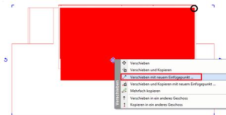
Verwenden Sie den Befehl **Verschieben mit neuem Einfügepunkt ...** um das Gebäude an seinen Platz zu verschieben.
