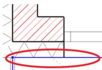
Versetzen Sie die Kante der äußeren Decke hinter die Dämmschicht.
