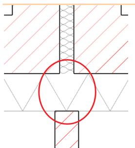
Die Trennwände werden in der Mitte der Wohnungstrennwände platziert.
