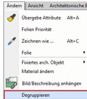
Aktivieren Sie dazu den Befehl **Degrupieren** aus dem **Ändern** Menü. Wählen Sie anschließend die Decke aus.
